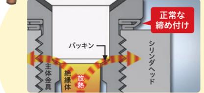
プラグが適切なトルクで締め付けられていると、絶縁体と主体金具はパッキンを介してしっかり密着しています。これにより、絶縁体を受けた熱は主体金具に伝わりシリンダヘッドへ移動し放熱されます。
