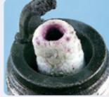
プラグの締め付けが不足していると、右図のようにプラグが緩んでいなくても密着していないため異常燃焼が起こり、「溶損」につながる場合があります。また、締め付け不足による異常燃焼が起こること「溶損」に至ると、エンジンが破損する危険性があります。
