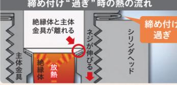
締め付け過ぎによりネジが伸びると、プラグの構造に緩みが生じ、絶縁体と主体金具が離れてしまいます。すると、絶縁体を受けた熱の移動が絶縁体と主体金具の間でスムーズに行われなくなり、絶縁体の温度が上昇するのです。
