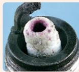
プラグを締め付け過ぎると、ネジ切れが起きていなくても主体金具が変形してしまいます。すると、右図のように絶縁体温度が上昇して異常燃焼が起こり「溶損」につながる場合があります。締め付け過ぎによる異常燃焼が起こること「溶損」に至ると、エンジンが破損する危険があります。
